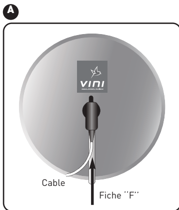
Antenne vue de face
